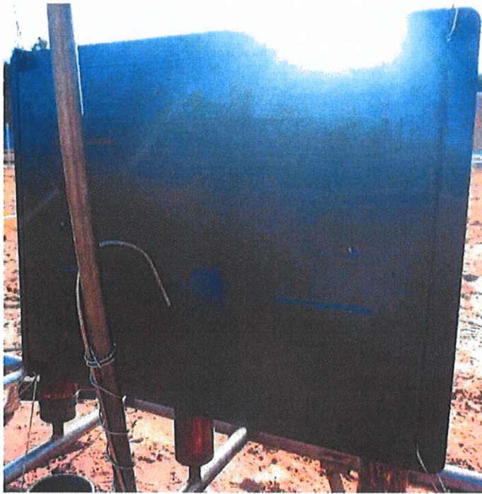
Bild 6: Position Thermoelement Feuertemperatur
