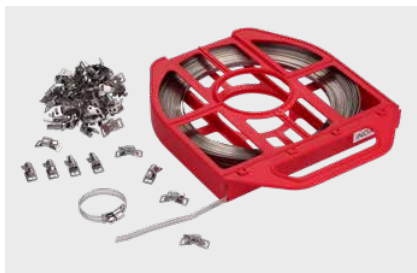
Artikelnummer 120078 Montageband aus VA-Stahl als Rollenware 30 m x 13 mm; Belastbarkeit bis 260 kp
